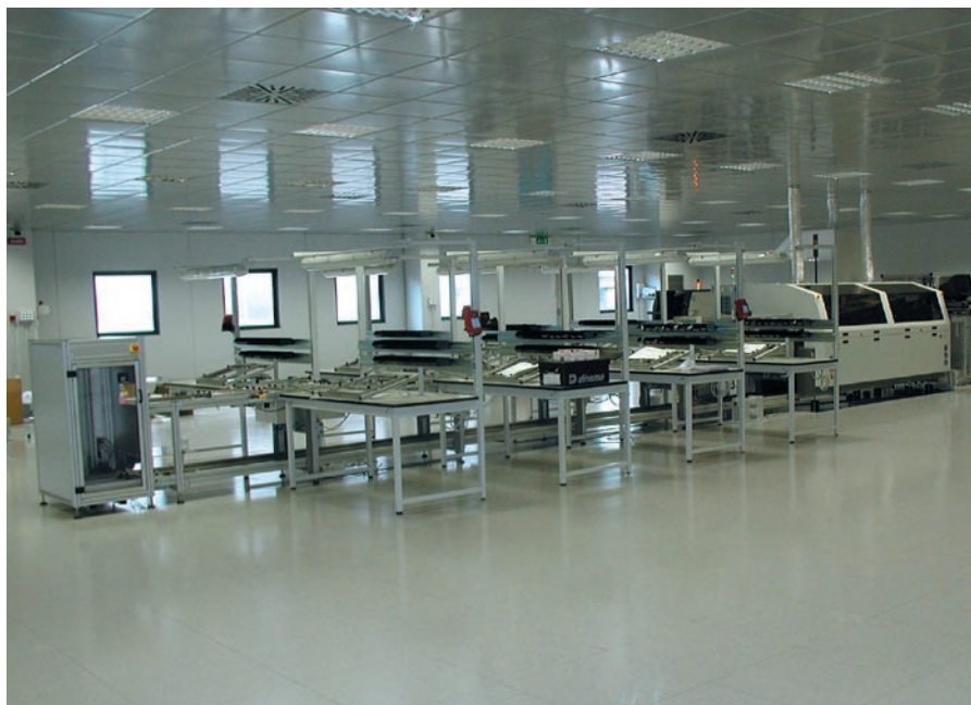
Linea con banchi di completamento e trasporto carrelli saldatura con ritorno convogliato sotto la saldatrice a onda DeltaWave di Vitronics Soltec
